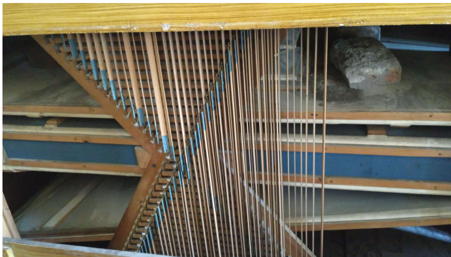
Obrázek 8 Mechanická traktura, kostel sv. Jana Křtitele
